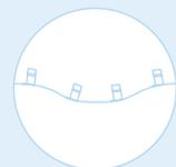
con l'utilizzo del supporto puntuale dell'elemento *Piedino* AERtegola®, il sistema non è vincolato alla struttura sottostante, ma è libero di adattarsi alla conformazione, anche irregolare, del piano di posa. Ciò risulta utile qualora si presenti una copertura antica, con i caratteristici avvallamenti del piano di appoggio.
